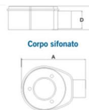
**Materiali** Corpo sifonato, filtro in ABS, canaletta e griglia in acciaio INOX AISI 304.
